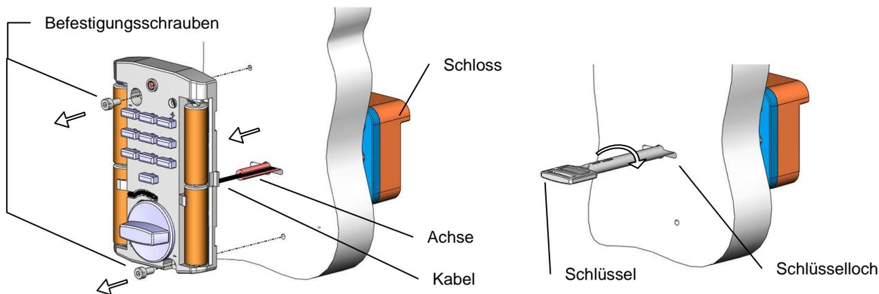
Je nach Montageart wurde das Kabel innerhalb der Achse in den Tresor verlegt (siehe Bild oben) oder durch eine separate Bohrung.
