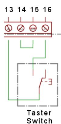
Abbildung 5 - Brücke für potentialfreies Sperrsignal
