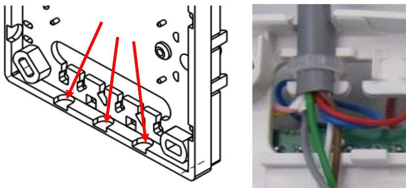
Abbildung 2 - Leitungsausbrüche, Zugentlastung
