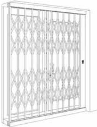
**Bild 5-6:** Scherengitter
