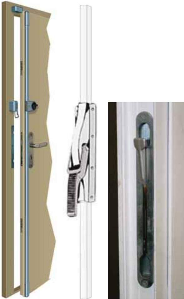
**Bild 3-22:** Stangenschloss, Treibriegel, verdeckter Betätigungshebel
