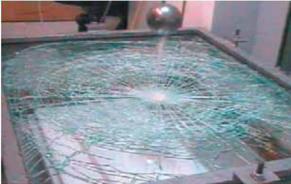
**Bild 4-1:** Verglasungsprüfung „auf Durchbruch“
