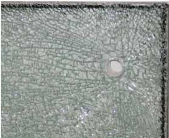
**Bild 3-4:** Bohrprüfung
