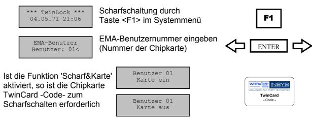
Benutzer 01 ! EMA scharf! Die EMA ist jetzt scharfgeschaltet. (akustisches Signal wird ausgegeben)
