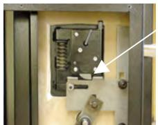
3. Achten Sie darauf, dass zwischen Ende des Schlossgehäuses und dem Blockierungsbalken des Safe-Riegelwerks ein Mindestabstand von 3,8 mm vorhanden ist.
