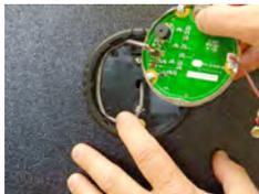
12. Das Schlosskabel sollte im Innern der Tastatureinheit – wie in der Abbildung dargestellt – verlaufen. Achten Sie darauf, dass das Kabel nicht geknickt oder gequetscht wird.
