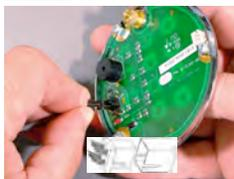
10. Stecken Sie das Schlosskabel in den Anschluss an der Unterseite des Tastaturfelds. Beachten Sie, dass Stecker und Anschluss nur dann ineinander passen, wenn der Stecker richtig ausgerichtet ist.
