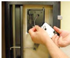
1. Die Montageoberfläche sollte glatt und eben sein und Löcher für Befestigungsschrauben der Dimension ¼-20 bzw. M6 aufweisen. Der Kabelkanal (Spindeloch) durch die Tresortür muss einen Durchmesser von mind. 7,9 mm aufweisen. Stecken Sie das Schlosskabel durch das Spindeloch und ziehen Sie es vorsichtig durch, während Sie gleichzeitig das Schlossgehäuse gegen die Montagefläche drücken.
