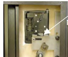
6. In diesem Foto wurde die Befestigung des Riegelwerks etwas gelockert, indem eine kleine Materialmenge von der rechten Seite der Riegelöffnung des Blockierungsbalkens entfernt wurde. Wenn sich nun das Riegelwerk vollständig in der Schließposition befindet, gibt es auf allen Seiten des Schlossriegels genügend Spielraum. Diese Anordnung wird bevorzugt.
