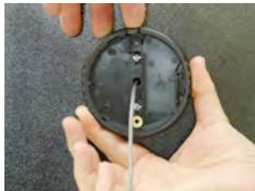
9. Sobald sich der Ring auf der Platte befindet, drehen Sie ihn im Uhrzeigersinn bis die Lasche nach oben zeigt. Möglicherweise müssen Sie die federbelastete Lasche nach vor ziehen, damit Sie den Ring in Position drehen können. Wenn die Lasche gerade nach oben zeigt, wird sie einrasten.
