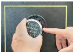
13. Die Batteriekabel sollten wie dargestellt verlaufen. Eine ordnungsgemäße Platzierung verhindert, dass bei Montage des Tastaturfelds die Kabeldrähte geknickt oder gequetscht werden.
