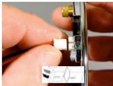
11. Wenn die Stromkabel (rot und schwarze Drähte mit weißem Steckverbinder) nicht bereits an die Tastatur angeschlossen wurden, stecken Sie den weißen Steckverbinder in den weißen Anschluss an der Rückseite des Tastaturfelds. Richten Sie den Steckverbinder so aus, dass dessen Rippe in den Anschlussschlitz passt.
