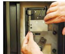
4. Wenn der Tresor über eine Platte für Wiederverschließvorrichtungen verfügt, wird diese am Schlossgehäuse – wie abgebildet – angebracht. Bei Anbringen mithilfe der Verschlusschrauben des Schlosses, achten Sie darauf, dass die Schrauben mit mindestens vier Gewindegängen am Schloss eingreifen. Falls erforderlich durch 8-32 Maschinenschrauben ersetzen. Es kann erforderlich sein, die längeren Schrauben auf eine geeignete Arbeitslänge zu kürzen.
