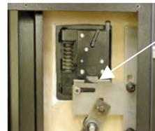
5. Das Schloss kann nicht ordnungsgemäß funktionieren, wenn es zu eng am Riegelwerk des Tresors anliegt. In diesem Bild wird das Riegelwerk in vollständig verschlossener Position gezeigt, wobei seitlich auf den Schlossriegel Druck ausgeübt wird. Dadurch könnte sich das Schloss nicht öffnen lassen.
