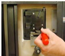
2. Nach Sicherstellung, dass das Kabel geschützt im eingefrästen Kanal des Schlosses liegt und an keiner Stelle geknickt oder zu gespannt ist, befestigen Sie das Schlossgehäuse mit den mitgelieferten Schrauben an der Montagefläche. Die Befestigungsschrauben mit 33,9 bis 45,2 dNm anziehen.
