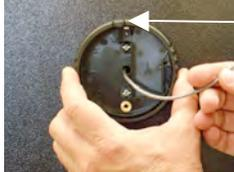
8. Setzen Sie den Tastaturring auf die Platte. Beachten Sie, dass sich oben am Ring eine federbelastete Lasche befindet (siehe weißer Pfeil). Richten Sie diese beim Aufsetzen des Rings auf die Platte wie abgebildet aus.
