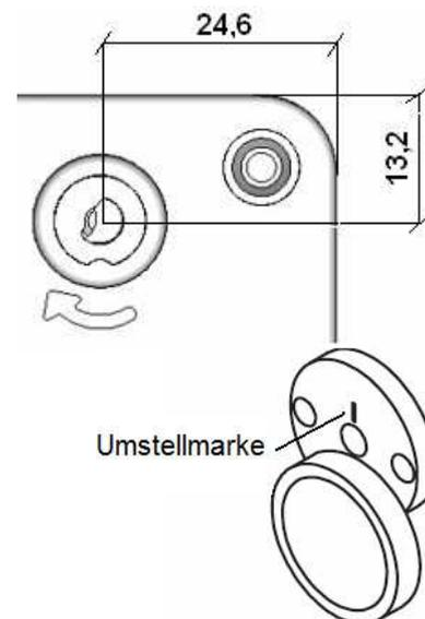
Montieren Sie das Schlüsselschild an der Tresor-Außenseite (wenn nötig). Stellen Sie sicher, dass die Umstellmarke richtig angebracht ist bei Schlossübergabe.
