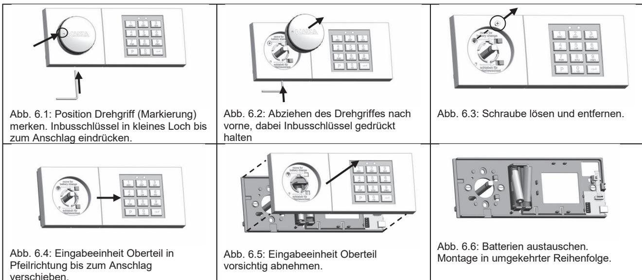
**Abbildung 6: Batterietausch**
